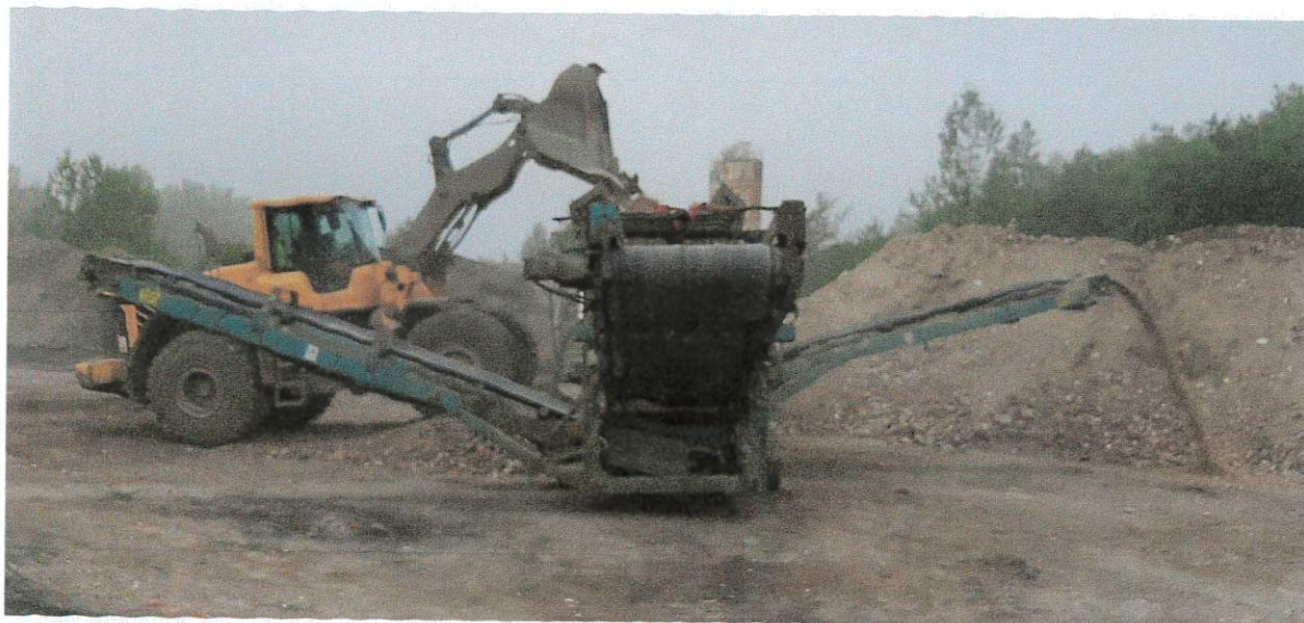
Obrázek č. 3. - Nasypání odpadu do vstupního zásobníku třídící linky
